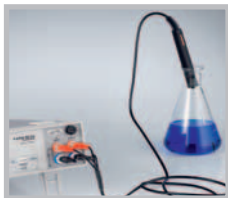
Temperaturmessung mit HZ887 in Verbindung mit HM8112-3
